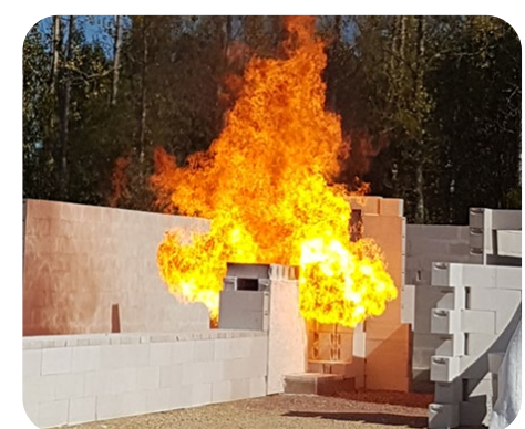
ISO 22899-1:2007 (jet fire test effectis®)
